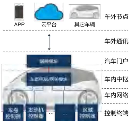
图 6-26 联合汽车电子产品业务信息安全分层防护架构
