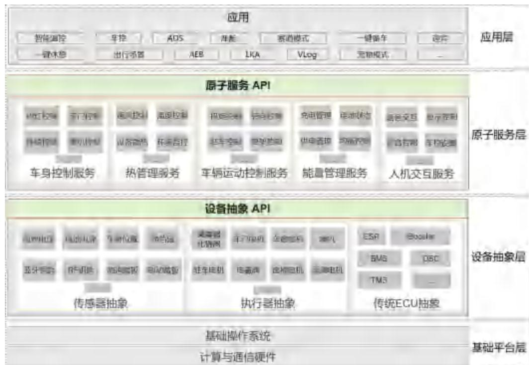
图 3-5 面向服务的软件架构示意图
